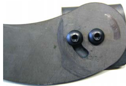
Fig.5: Assemblaggio della staffa sagomata sulla staffa di fissaggio - Assembling between the shaped bracket and the fixing bracket
